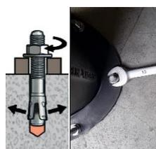
Munissez-vous d'une clé de serrage **13 mm** et serrez au maximum les écrous sur les 5 goujons.
