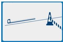
Prevoir 5 à 10 mm et et adaptez la longueur du profilé . Laissez un écart de 1 cm doit entre chaque profilé mit bout à bout afin de permettre l'évacuation des eaux.
