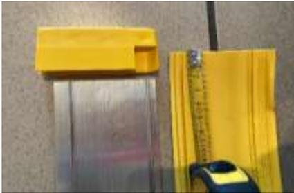
**ETAPE 1 :** Couper le(s) rail(s) en fonction de la longueur à protéger, en coupant le rail à chaque extrémité 2 cm plus court que la plinthe/lisse murale afin de pouvoir insérer l'embout.
