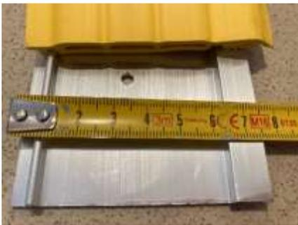
**ETAPE 2 :** Percer le(s) rail(s) à environ 5 cm des extrémités puis tous les 50 à 70 cm. Centrer les trous afin que les vis se retrouvent dans l'alvéole centrale de la plinthe/lisse, pour éviter que la vis ne provoque une protubérance une fois posée.
