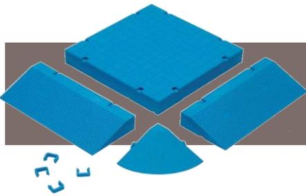
Les dalles **GAROCHUT®** se présentent sous forme d'éléments de dimensions : 250 x 250 x ep. 40mm. Chaque côté de la dalle comporte 2 trous d'assemblage, (soit 8 trous d'assemblage par dalle). Les éléments de finition sont les bords d'approche et les angles d'approche avec bord chanfreiné. Les bords sont équipés de 2 trous d'assemblage sur le côté, et les angles de 2 points d'accroche.
