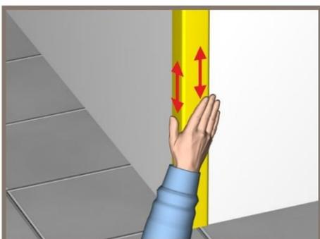
**ETAPE 3 :** Appuyer sur l'Angl'isol® pour répartir la colle et assurer le contact avec le mur. Retirer le scotch de masquage.
