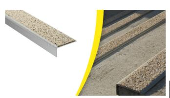
Le nez de marche cornière minéral est constitué de résine et de granulats de marbre. Il évite la dégradation des bords de marche et protège contre la glissance. La largeur de l'antidérapant est de 3 cm ou 5 cm.
