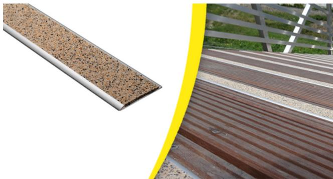
Le nez de marche plat minéral est constitué de résine et de granulats de marbre offrant une excellente résistance à la glissance, notamment en environnement humide. L'angle d'attaque de son profilé est optimisé (< 30°) pour ne pas être accidentogène. La surface antidérapante contrastée est de 3 cm ou 5 cm.
