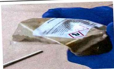
3. Finaliser le mélange manuellement jusqu'à l'obtention d'une couleur uniforme sur la totalité du volume, y compris dans les angles, puis continuer à mélanger pendant 30 secondes.
